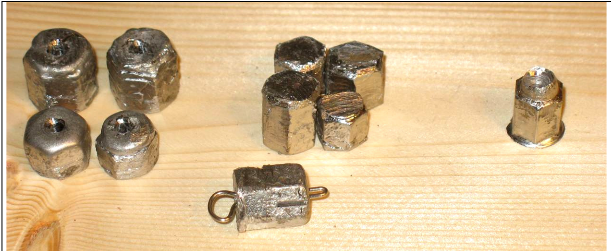
Bild 2: ...und verschiedene Stufen der Bleie vom ‚Rohling‘ bis zum gebohrten Blei mit Öse
