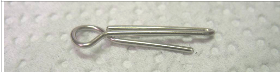
Bild 7: ...und der Draht ca. 3mm unterhalb der 180°-Biegung abgeknipst
