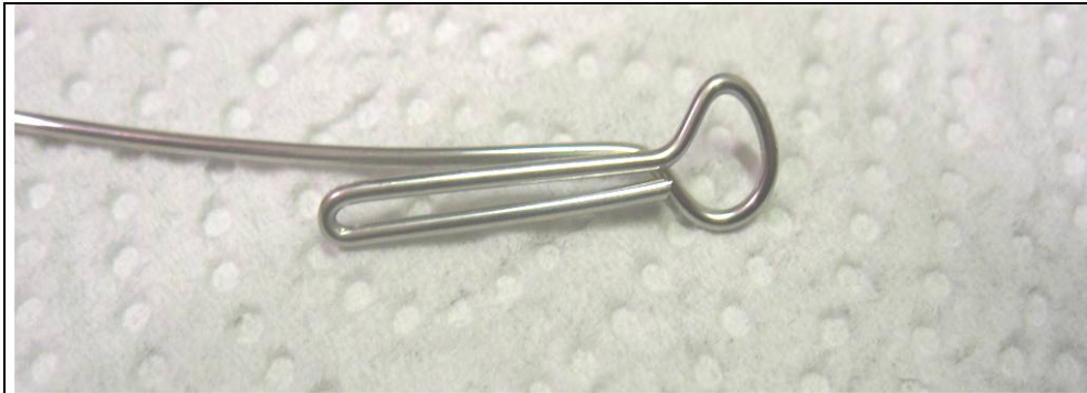
Bild 6: Die Rund-Öse wird gebogen...
