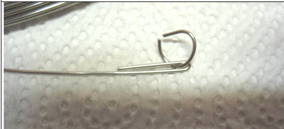
Bild 5: ...und mit einer Flachzange die haarnadelförmige Öse eingestellt
